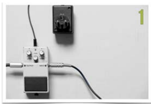
BRANCHEMENT TYPIQUE D'UNE ALIMENTATION EXTERNE
