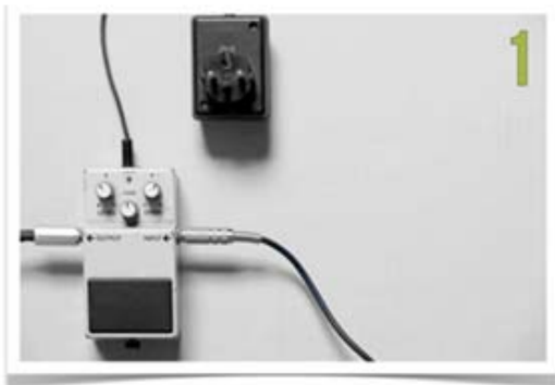
BRANCHEMENT TYPIQUE D'UNE ALIMENTATION EXTERNE
