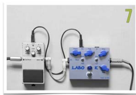
POSSIBILITE D'UTILISER LA PILE INTERNE DE LA LABO ★ K POUR ALIMENTER UNE 2EME PEDALE VIA LE CORDON POWER-LINK
