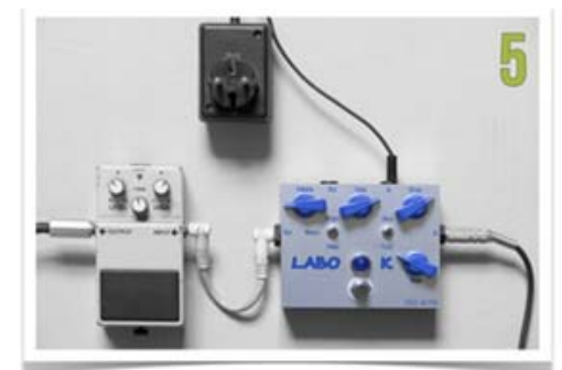
ALIMENTATION EXTERNE DANS LE CONNECTEUR "IN" DE LA LABO ★ K
