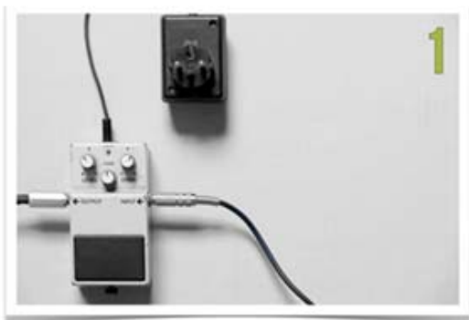
BRANCHEMENT TYPIQUE D'UNE ALIMENTATION EXTERNE
