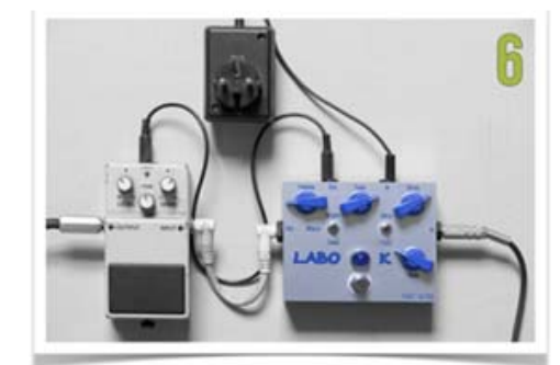
ALIMENTATION DE LA DEUXIEME PEDALE AVEC LE CORDON POWER-LINK
