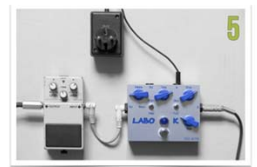
ALIMENTATION EXTERNE DANS LE CONNECTEUR "IN" DE LA LABO ★ K
