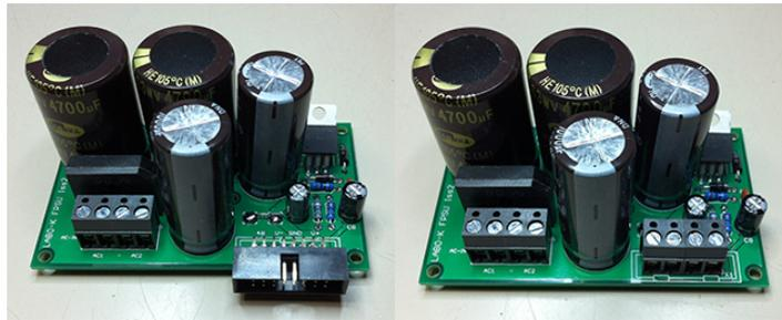
Implantation d'un strap sur le PCB.
