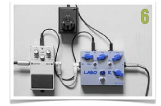
ALIMENTATION DE LA DEUXIEME PEDALE AVEC LE CORDON POWER-LINK
